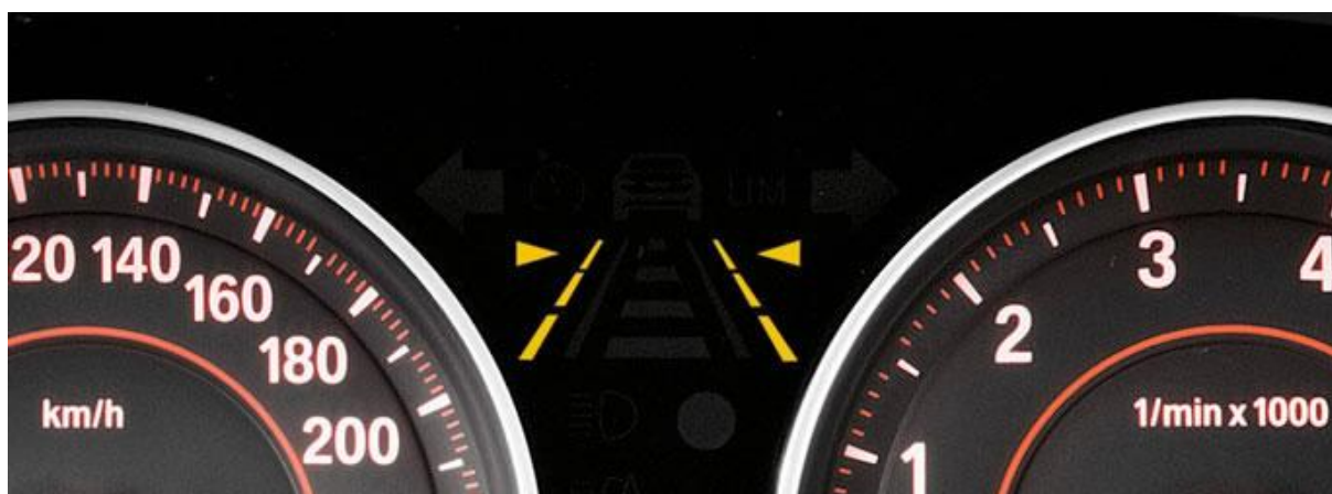
Rys. 4. System obserwacji pasa ruchu - Active Driving Assistant firmy BMW [13]
