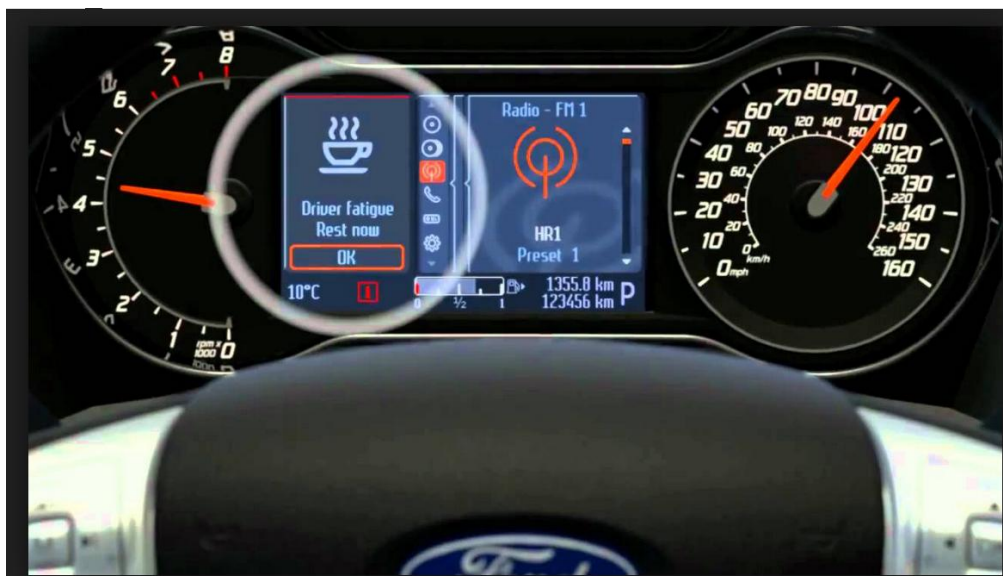
Rys. 3. System Driver Alert firmy Ford - widok kokpitu [12]
